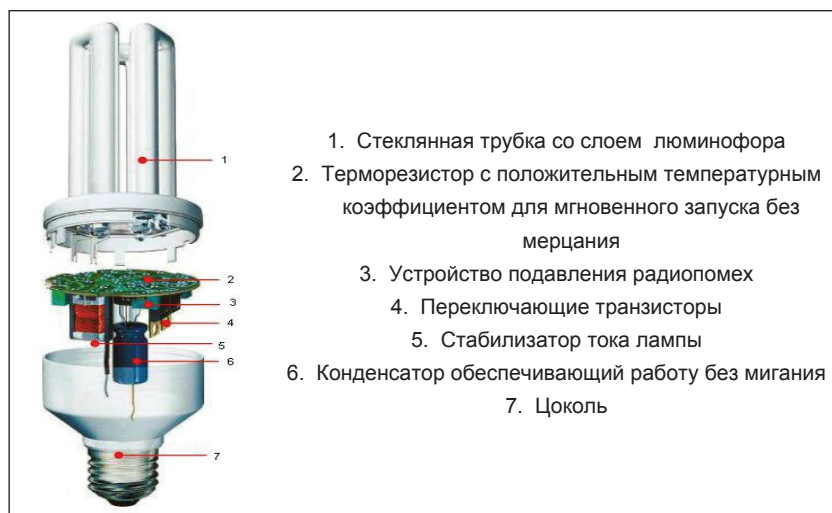
Рис. 1. Устройство КЛЛ
