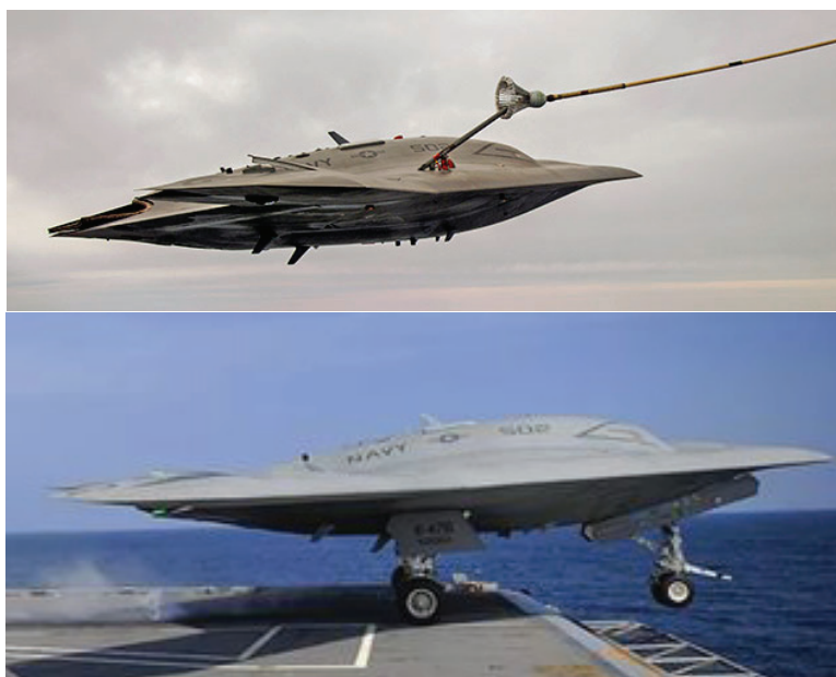
Рис. 4. X-47В в момент дозаправки в воздухе и в момент отрыва от палубы авианосца
