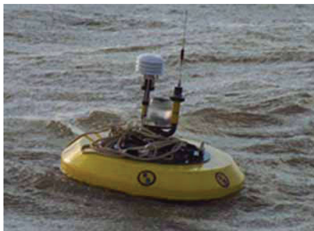
Рис. 3. Метеорологический буй, питающийся от осадочного МТЭ
