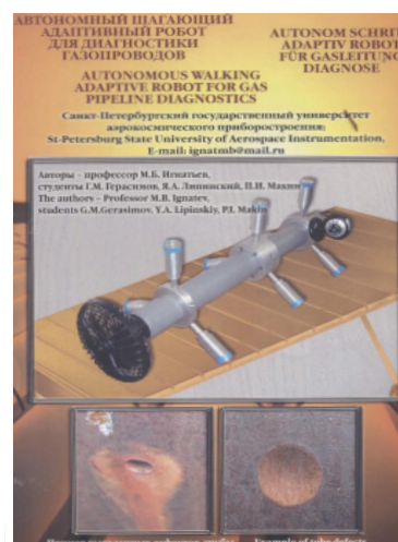
Рис. 6. Экспериментальный образец автономного шагающего робота для диагностики газопроводов
