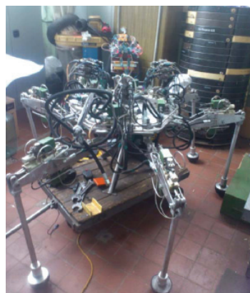
Рис. 3. Шестиногий робот с гидроприводами, вид сбоку
