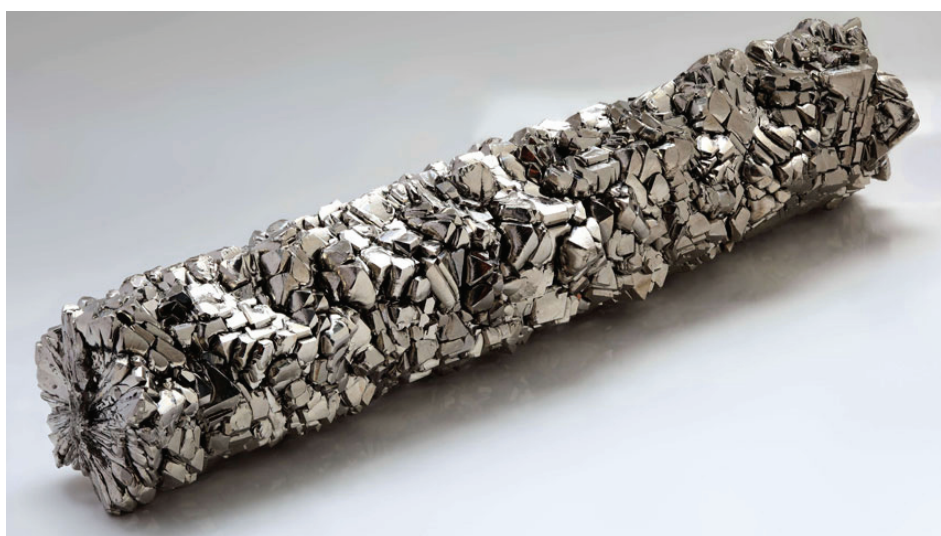
Рис. 1. Брусок кристаллического титана, изготовлен иодидным методом (чистота – 99,995 %, вес ~ 283 г, длина ~14 см, диаметр ~25 мм)
