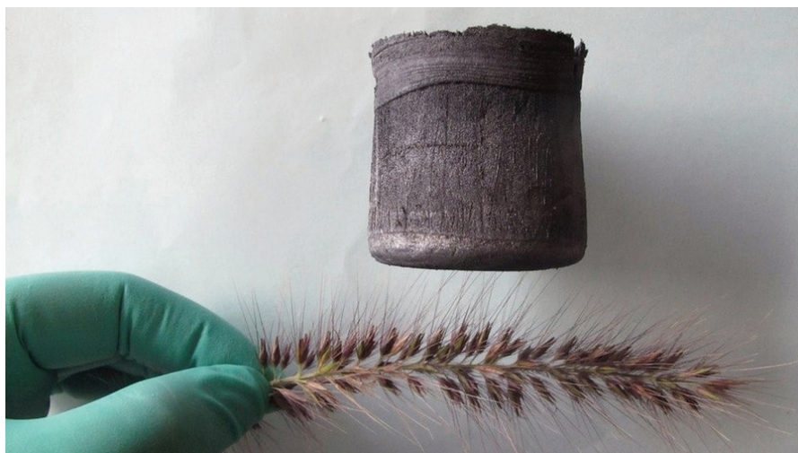
Рис. 2. Графеновый аэрогель, плотность – 0,16 \text{ мг/см}^3
