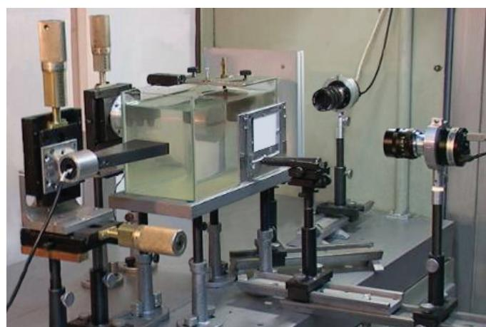
Рис. 8. Экспериментальная установка для наблюдения трехмерных рефрактограмм
