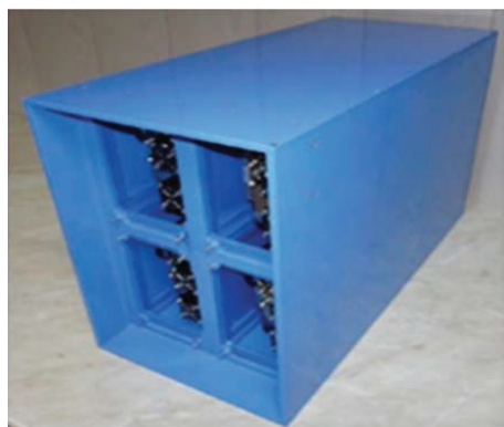
Рис. 10. Синхронная антенная излучающая решетка (а), эксперимент по прохождению СШП-сигнала в свободной атмосфере (б)
