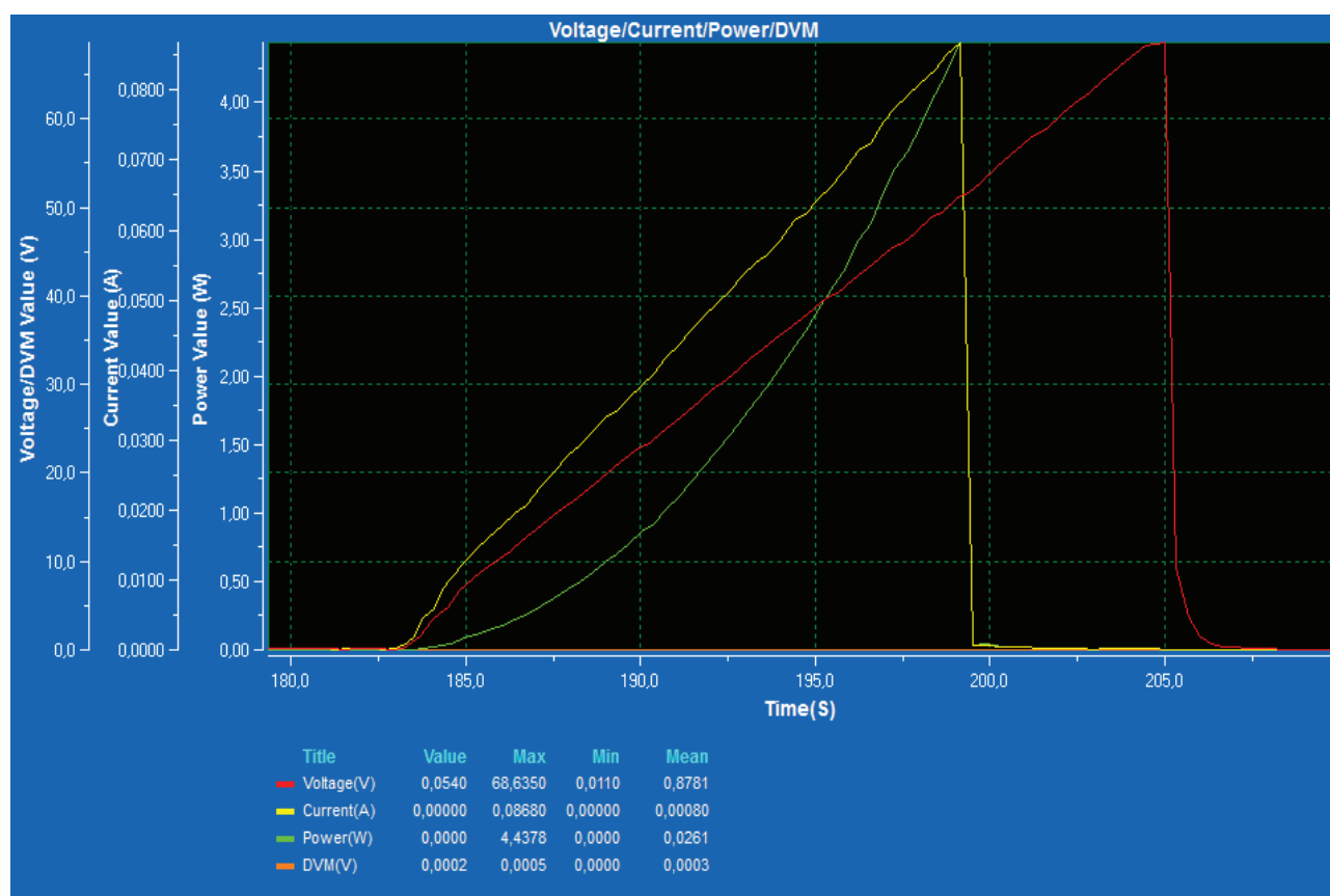
Рис. 4. ВАХ НГ-пленки толщиной 1 мкм на кварцевой подложке при комнатной температуре. Как видно, отключение тока предшествует отключению напряжения, т. е. отключение происходит по внутренней причине, однозначно связанной исключительно с величиной тока
