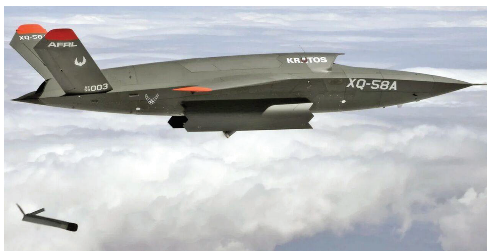
Рис. 2. БЛА XQ-58A Valkyrie демонстрирует сброс небольшого разведывательного БЛА ALTIUS-600 в ходе летных испытаний
