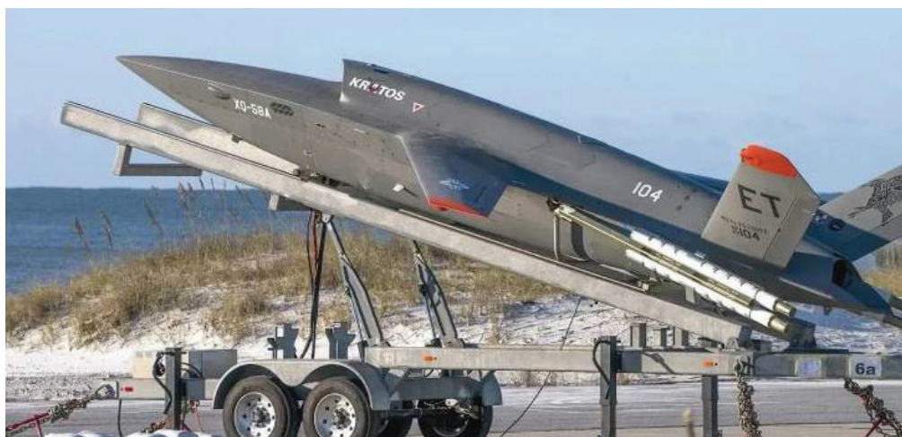
Рис. 1. БЛА XQ-58A Valkyrie перед запуском на автомобильном прицепе с твердотопливными стартовыми ускорителями
