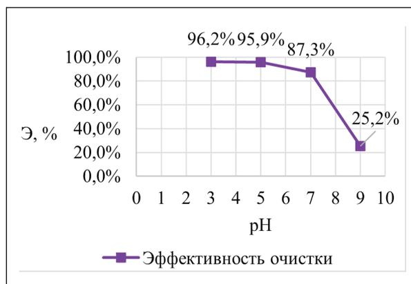
**Рис. 7. Зависимость эффективности очистки магнитными гранулами хитозана от рН среды**
