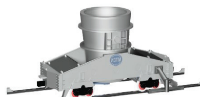
Сталевозы самоходные грузоподъемностью свыше 240 т
