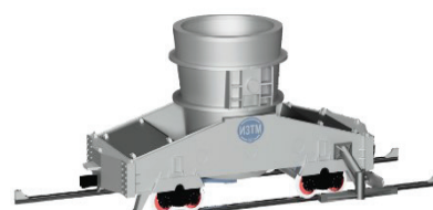
Сталевозы самоходные грузоподъемностью свыше 240 т
