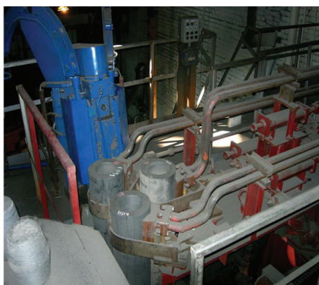
Рис. 2. Агрегат комплексной обработки стали в ковше емкостью 15 т с тремя электродами на одной траверсе
