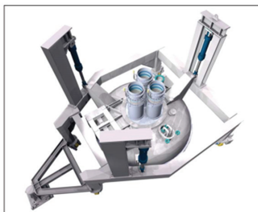
Рис. 1. Схема механизма перемещения и подъема крышки
